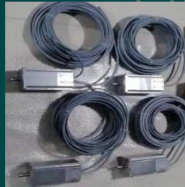
于19年研制成功可供广泛使用的BSD110-100-R1-R型1E6 Gy级耐辐射伺服电机，对标美国、瑞士同类产品，额定输出功率2.2kW；20年在中国散裂中子源国家实验室，11号站线（大气中子谱仪）散射室中试用；同时研发出BSD90-50-R1-R等其它系列型号，并向中核集团、海军等单位逐步推广。1E6 Gy是辐射防护装备及部件的一个重要等级，可以保证系统在大多数强辐射领域正常工作，在超强辐射环境下也具有一定的可靠性和工作时间（如日本福岛核事故现场近核心区域）。全球主要供应厂商只有美国的倍福（Beckhoff），瑞士的瑞诺（Infranor），以致国内的一些军工项目，也只能高价采购瑞诺的电机；导致价格极其昂贵，且供货不稳定，周期长，在特殊国际环境下易受限制，严重影响国内相关应用。
